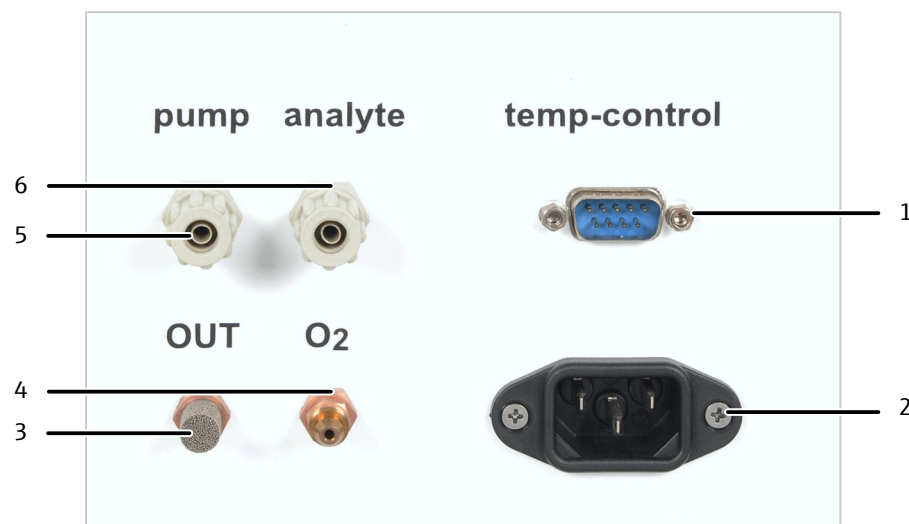
Fig. 4 Raccords à l'arrière du module pour solides
